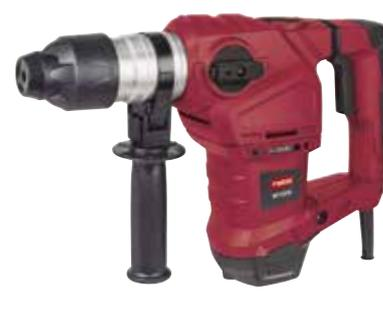
**Taladro electrónico Ratio TR750NM** 750 W. 0-3.000 rpm. 0-48.000 ipm. Peso 1,8 kg. Maletín de transporte. 7993X208
