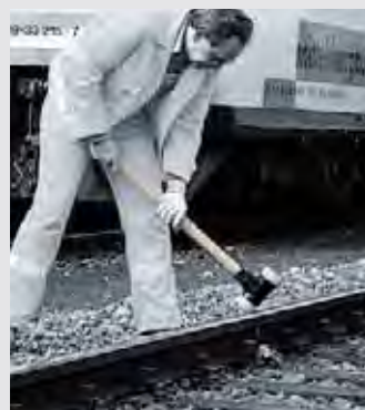
Las carcassas de seguridad de fundición maleable con recubrimiento de polvo unen de forma segura cabezal y mango. Martillo de 840 mm, una longitud ideal para aplicaciones especiales como la construcción de vías férreas.
