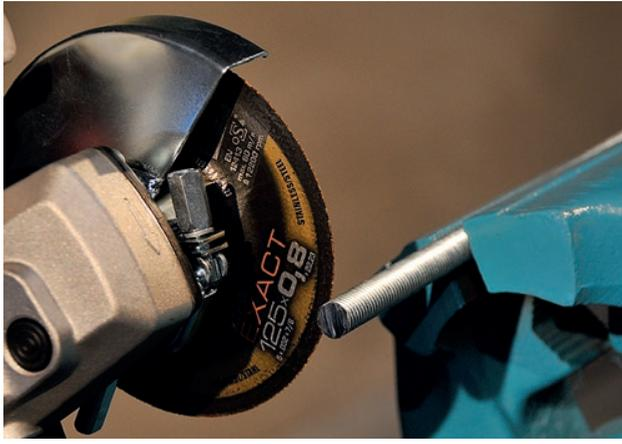
Los discos de corte extrafinos disponen de una superficie de fricción menor. Esto permite un corte rápido y en frío.
