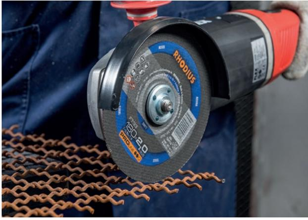
Los discos de corte para máquinas manuales suelen usarse para aplicaciones robustas. Gracias a un tejido más fuerte y un espesor de disco de hasta 4 mm ofrecen mayor estabilidad y mayor tacto al cortar materiales sólidos.
