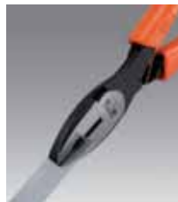
Los alicates universales se utilizan tanto para cortar como para agarrar.
