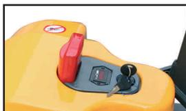
Protección contra descarga total de la batería. Con botón de parada de emergencia e indicador de descarga. Esta protección asegura una mayor vida de la batería.
