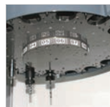
Cambio de herramientas · Automático con cargador para 16 herramientas.
