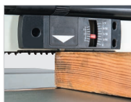
· Ajuste de la altura de regrueso.
