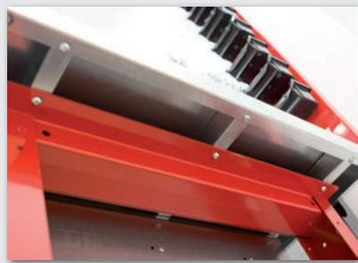
Encimera plancha de acero cincado de 2mm de grosor con 3 travesaños de refuerzo longitudinal colocados en forma de U (altura 40mm) proporciona un perfil de 42mm de gran robustez.
